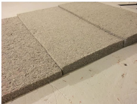
Figur 2: De tre tjocklekarna av iCell Skiva som mättes: 45, 70 och 95 mm.
